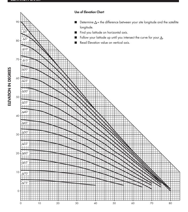
"  $\triangle$  " IS THE DIFFERENCE BETWEEN THE EARTH STATION ANTENNA SITE LONGITUDE AND THE SATELLITE LONGITUDE
